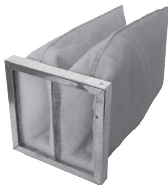
Фильтры карманного типа ФВК, класс очистки G3-F9 (EU3-EU9), предназначены для очистки от пыли наружного рециркуляционного воздуха в системах приточной вентиляции и кондиционирования воздуха. Фильтры изготавливаются по ТУ 4863-015-04980426-2003, ГОСТ Р 51251-99.
