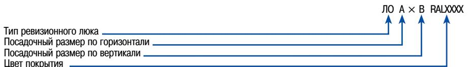
**ПРИМЕР:** 1) **ЛО 600×300 RAL9010** – ревизионный люк обслуживания с посадочными размерами 600 мм по горизонтали и 300 мм по вертикали (размер проема для обслуживания при открытом люке будет равен 530×293 мм). Цвет решетки по каталогу – RAL9010;
