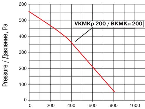
Extract capacity / Производительность, m³/h
